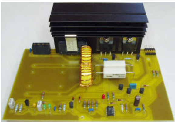
Gut zu sehen ist hier der Kühlkörper mit den beiden Leistungstransistoren und dem mit Metallfeder befestigten Brückengleichrichter.
